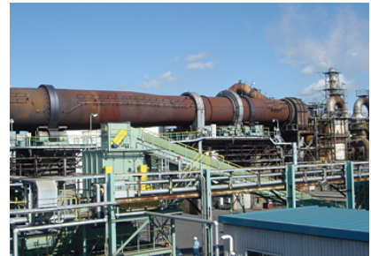
J X金属苫小牧ケミカル ロータリーキルン式焼却炉
